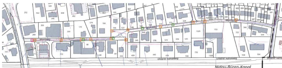
Abbildung 3: Ausführungsplan Kanalisation (Legende: rot = Schacht komplett Ersatz, orange = Schacht Instandstellung, grün = Sondagen Kanalisationersatz)
