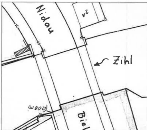
Abb. 38: Schlossbrücke von 1931, Situation 1:500. Ausschnitt aus einem privaten Vermessungsplan. Brücke hat nun auf beiden Seiten ein Trottoir. Breite zwischen den Brückengeländern: 12 m. Länge, d.h. lichte Weite zwischen den Brückenwiderlagern: 12 m (unverändert wie Brücke von 1877).
