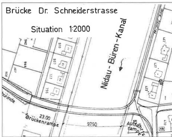
Abb. 83: Dr.-Schneider-Brücke 1973/75. Länge der eigentlichen Flussbrücke: 97,5 m. Länge der Brückenrampe auf der Südseite zur Überquerung der Burgerallee: 23 m. Rechts im Bild die Auffahrtsrampe bei der Dr.-Schneider-Strasse und dem Balainenweg. Längs Südufer des Kanals führt neben der Burgerallee ein «Trampelpfad» unter der Brücke hindurch und längs des Nordufers ein Fussweg, auch benützbar für Zweiradfahrer.
