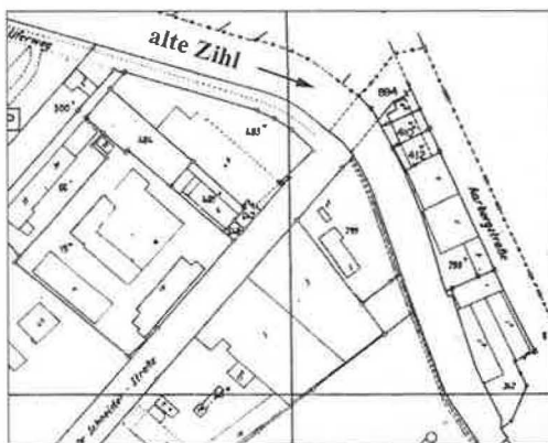
Abb. 47: Ausschnitt aus Übersichtsplan 1:4000, Gemeinde Nidau, 1988. Die Industriebrücke überquert die alte Zihl bei der Einmündung der Dr.-Schneider-Strasse in die Aarbergstrasse. Die Gemeindegrenze Nidau/Biel springt dort von der Ostseite der Aarbergstrasse an das östliche Ufer der alten Zihl. Die Brücke befindet sich ganz auf Nidauer Gemeindegebiet.
