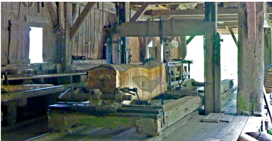
Abb. 8: «Innenausstattung» der heute noch bestehenden und mit mechanischer Kraftübertragung betriebenen Säge in Heimenhausen / BE.
