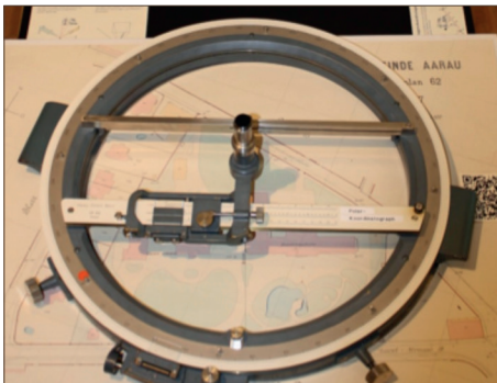
Polaraufnahmen/Polarkoordinatograph/Theodolit: Ab ca. 1850 bis ca. 1970
