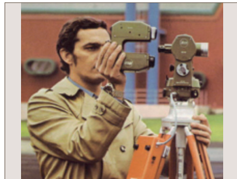
Elektronische Distanzmessung/Tachymeter: Ab ca. 1970 bis heute
