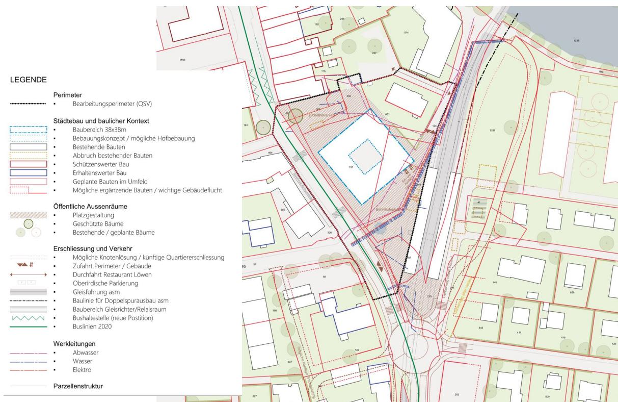
Parkierung erfolgt direkt von der Hauptstrasse her über den Bahnhofplatz. Die Tiefgarageneinfahrt ist in das Gebäude zu integrieren. Die Einfahrt erfolgt rückwärtig in Abstimmung mit der Anlieferung für den Grossverteiler.
