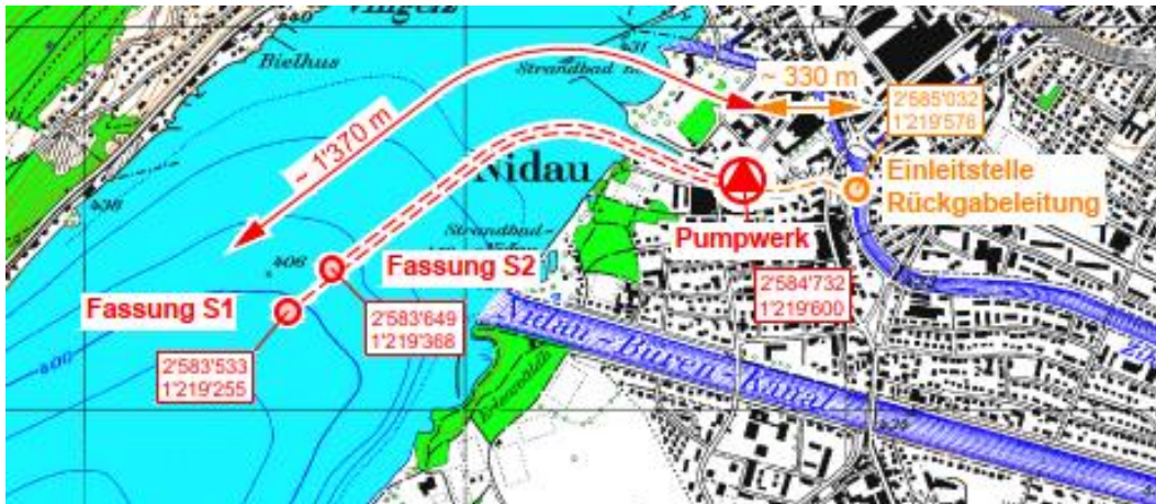
Abbildung 6: Koordinaten Fassung, Pumpwerk und Rückgabe
