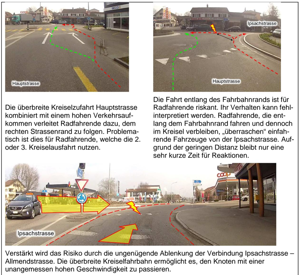
Abbildung 6: Mängel der best. Anlage: Einfahrt Hauptstr., Ablenkungswinkel Ipsachstr.
